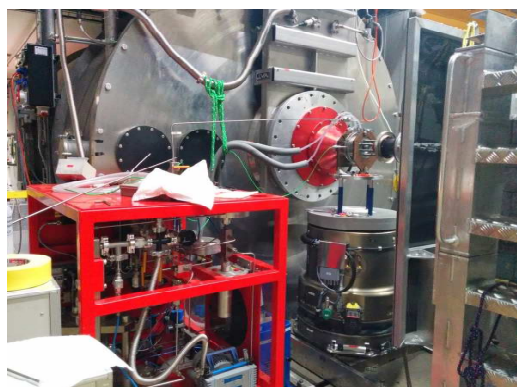
Fig. 3 高圧中性子散乱実験用の設備
